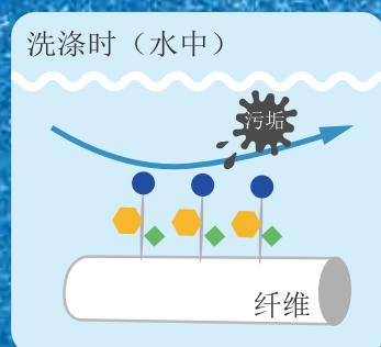
\*根据flip-flop现象，在空气中疏油基、疏水基防污，在水中亲水基去污。
