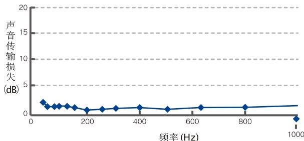
※按声音传输损失（声音阻抗管法ASTM E2611-09）进行隔音性能评定。
