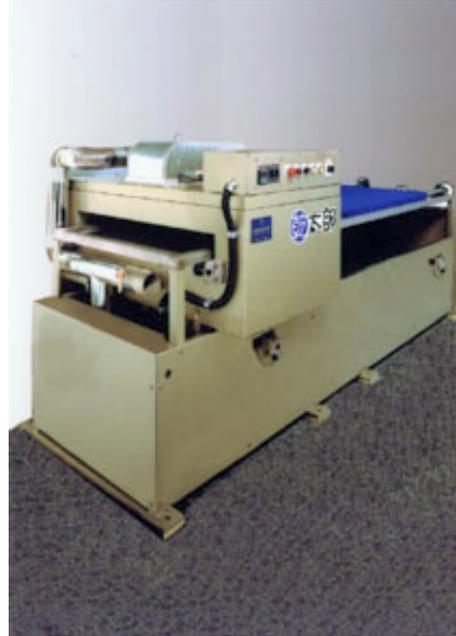
「乾太郎」は製品の風合いを重視して、上下吹出熱風循環機構内蔵の乾燥機を移動させるという、特許出願・業界初の画期的な方式を採用、さらに超広幅の製品に対応できるセット機能を装備し、染色メーカーの本格的装置と同様の高性能を有しながら、省スペース化による製造コスト低減の低価格を実現しました。
