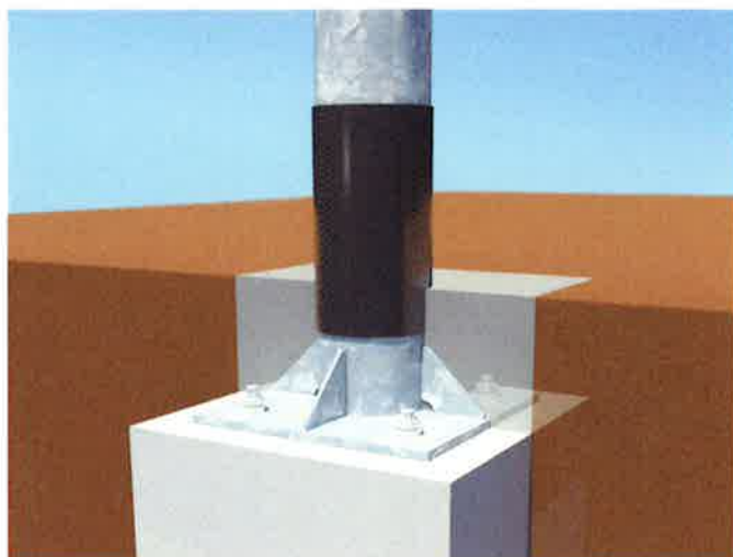
<防蝕・補強工事後>
