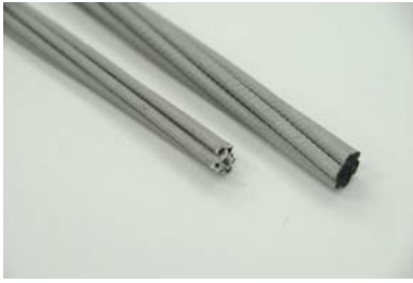
炭素繊維をねじって組紐状にした “カボコーマ・ストランドロッド”
