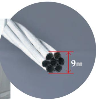
「CABKOMA ストランドロッド」を巻き取ったロール。約160mで12kgと軽量で、手で持ち運びができる。同等の強度を持つメタルワイヤなら約5倍の重量になる
