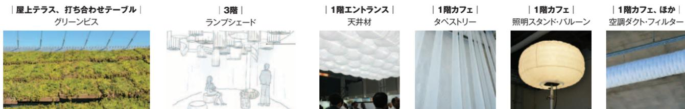
ファブリック・ラボラトリー「ファーボ」の内装や家具・照明には、小松精練の技術を生かした繊維が随所に使用されている。保水セラミックスパネル「グリーンピズ」は屋上と、屋内テーブルの天板や壁材として使われている。そのほか、真っ白な繊維に、小松精練の染色加工技術でさまざまな表情、テクスチャーを創り出したファブリックを、照明器具、採光制御、空調設備などに採用。繊維素材の建築空間への新しい活用提案を一覧することができる
